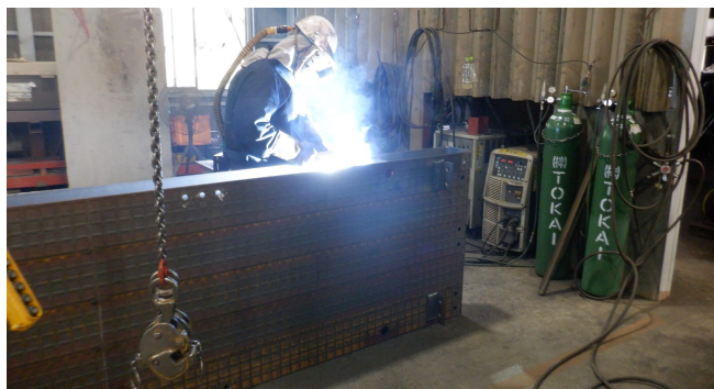
長尺のボックス材を吊りながらの溶接
