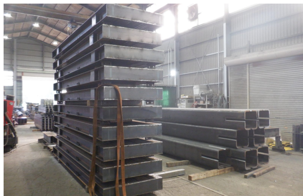
溶接を終えた大型部材の段積み（出荷前）
