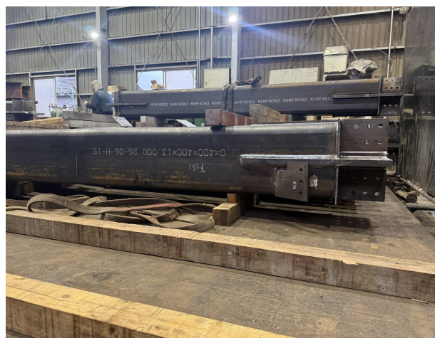
ブラケットを取り付けた角形鋼管柱（BCR295 □400×400×13）
